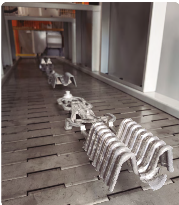
Pieza metálica inyectada en la Bole MG 300 Thixomolding.
