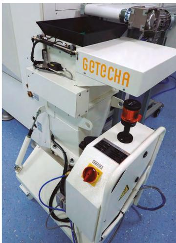
de plásticos, con capacidades de **hasta 3,5 toneladas por hora**, diámetros de rotor de hasta 800 milímetros con hasta siete cuchillas móviles y cuatro cuchillas fijas. Además, están diseñados para manejar condiciones especiales, como la presencia de materiales contaminantes como la arena y el metal, así como niveles elevados de humedad y contaminación en los productos suministrados, como macetas y botellas.
