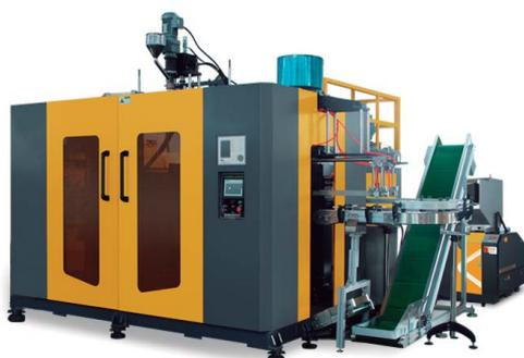
*Proyecto llave en mano: sopladora, molde y sistema de automatización de final de línea.*
