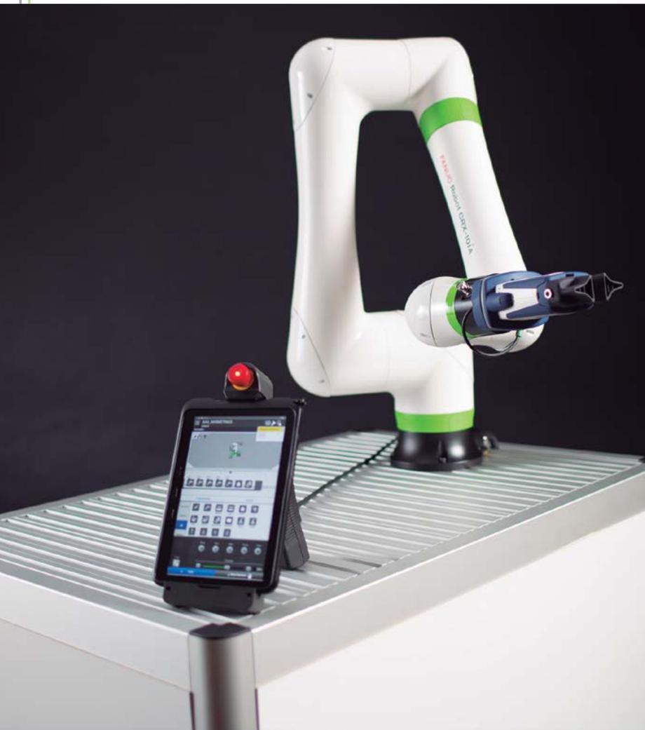
Para que el robot ofrezca la máxima fiabilidad, puede funcionar en modo colaborativo a una velocidad máxima de 1.000 milímetros por segundo, así como en modo estándar, a una velocidad de hasta 2.000 milímetros por segundo. El cambio de modo colaborativo a estándar resulta muy útil, por ejemplo, por la noche o los fines de semana, cuando el robot puede realizar tareas sin personas cerca.
