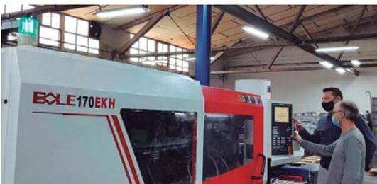
Asimismo, Taurus ha destacado el funcionamiento rápido, preciso y silencioso de las inyectoras Bole. En este sentido, el sistema de cierre y su servo de baja inercia, junto con las válvulas proporcionales en el grupo hidráulico, hacen que la máquina sea realmente silenciosa y economice al máximo tanto el uso de material como de energía eléctrica.
