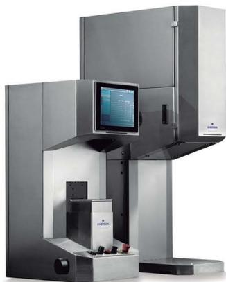
Los equipos Branson láser GLX establecen nuevos estándares de precisión y rendimiento, con una fuerza de sujeción baja en la industria de producción de pequeños componentes, soldaduras instantáneas y sin partículas para mejorar la calidad, ciclos de soldadura repetibles más rápidos y fácil acceso a los datos de producción.
