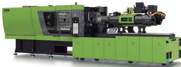
Engel sentó un precedente en la K2010, cuando presentó la primera inyectora e-cap totalmente eléctrica. Hasta entonces, el estándar de inyectoras para fabricar tapones venía dado por máquinas hidráulicas con acumuladores para el movimiento de inyección.
