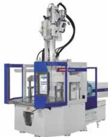
La nueva inyectora vertical VPower CombiMould con un paquete especial de automatización fue una de las novedades de la firma austriaca. En una VPower 120/130H/210V, se fabricó un enchufe de PA y TPE para la industria automotriz con un molde de 2+2 cavidades.
