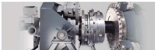
permite aumentar la velocidad de aceleración y reducir el tiempo de parada. Permite cortes de piezas pequeñas, incluso de 50 cm o menos, y un cambio de cuchillas fácil. Durante la feria también podrá verse una línea de producción de cambio rápido de diámetro y espesor de tubería en línea.
