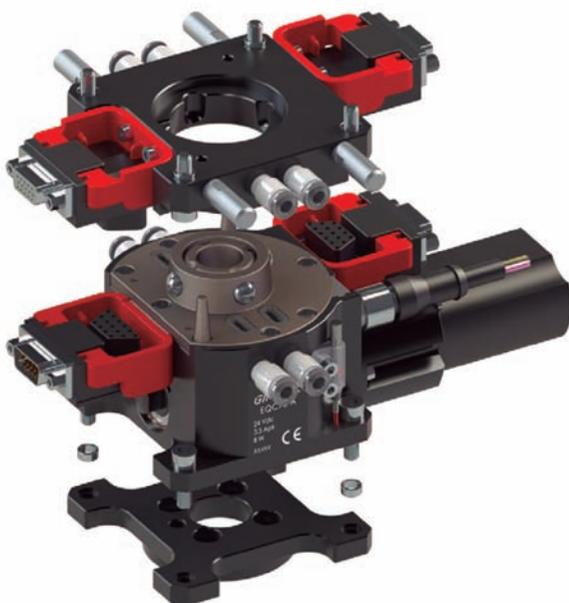
El driver está integrado en el producto y la motorización es siempre brushless. En el cambio automático de herramientas EQC75, el sistema de cambio está compuesto por dos partes, la activa EQC75-A, que se fija a la muñeca del robot, y la pasiva EQC75-B, que es la brida de acoplamiento para la herramienta, la parte intercambiable del sistema.
