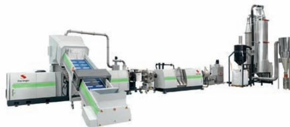
El film de LDPE, obviamente, no era un desafío, pero el alto contenido de papel requería una extensión de la línea con un paso adicional del proceso: reducción del olor. Mediante una preparación óptima del material en el alimentador Smart feeder y una excelente desgasificación en el módulo C-VAC, este proceso ya extrae una gran parte del olor durante la extrusión y la unidad de extracción de olores mejora aún más la calidad de la granza final.
