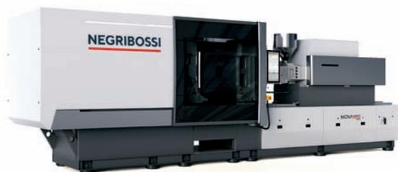
La serie Nova se lanza en dos versiones, servohidráulicas (NOVA s) e híbridas (NOVA i). También hay disponible un modelo completamente eléctrico (NOVA e) en el rango de 50 a 350 toneladas (en la imagen).
