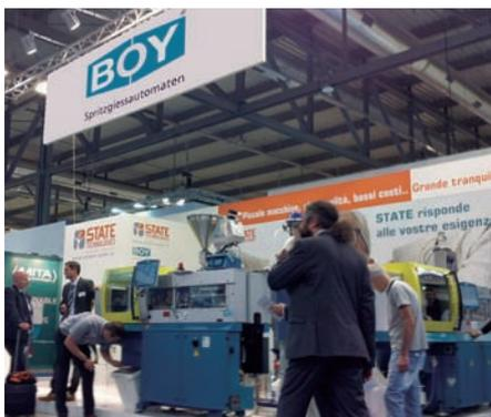
El fabricante de inyectoras alemán Dr. Boy llevó a la Plast uno de sus modelos estrella, la Boy 35 E, equipada con un reómetro, para determinar las propiedades de flujo del material, en este caso caucho, permitiendo al usuario analizar las propiedades del material antes de la producción. Esto garantiza una producción de piezas con absoluta repetibilidad, controlando con precisión
