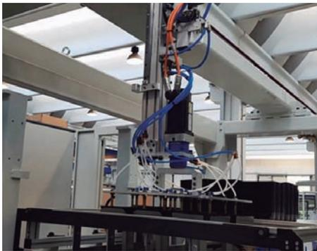
Robot de apilamiento para la termoformadora ACF, de Amut-Comi.
