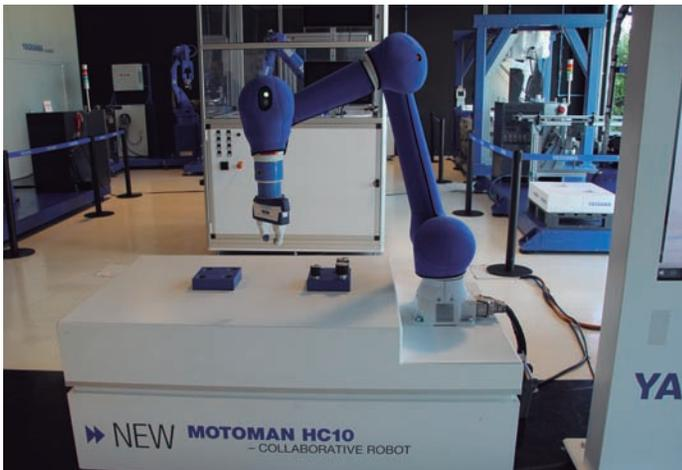
Por otro lado, la función de seguridad de seguimiento de la velocidad permite al robot y la persona trabajar juntos: si el operador entra en el área de interacción, el robot es seguro o se mueve por debajo de la velocidad de seguridad permitida. Las normas de seguridad correspondientes se cumplen en todo momento.
