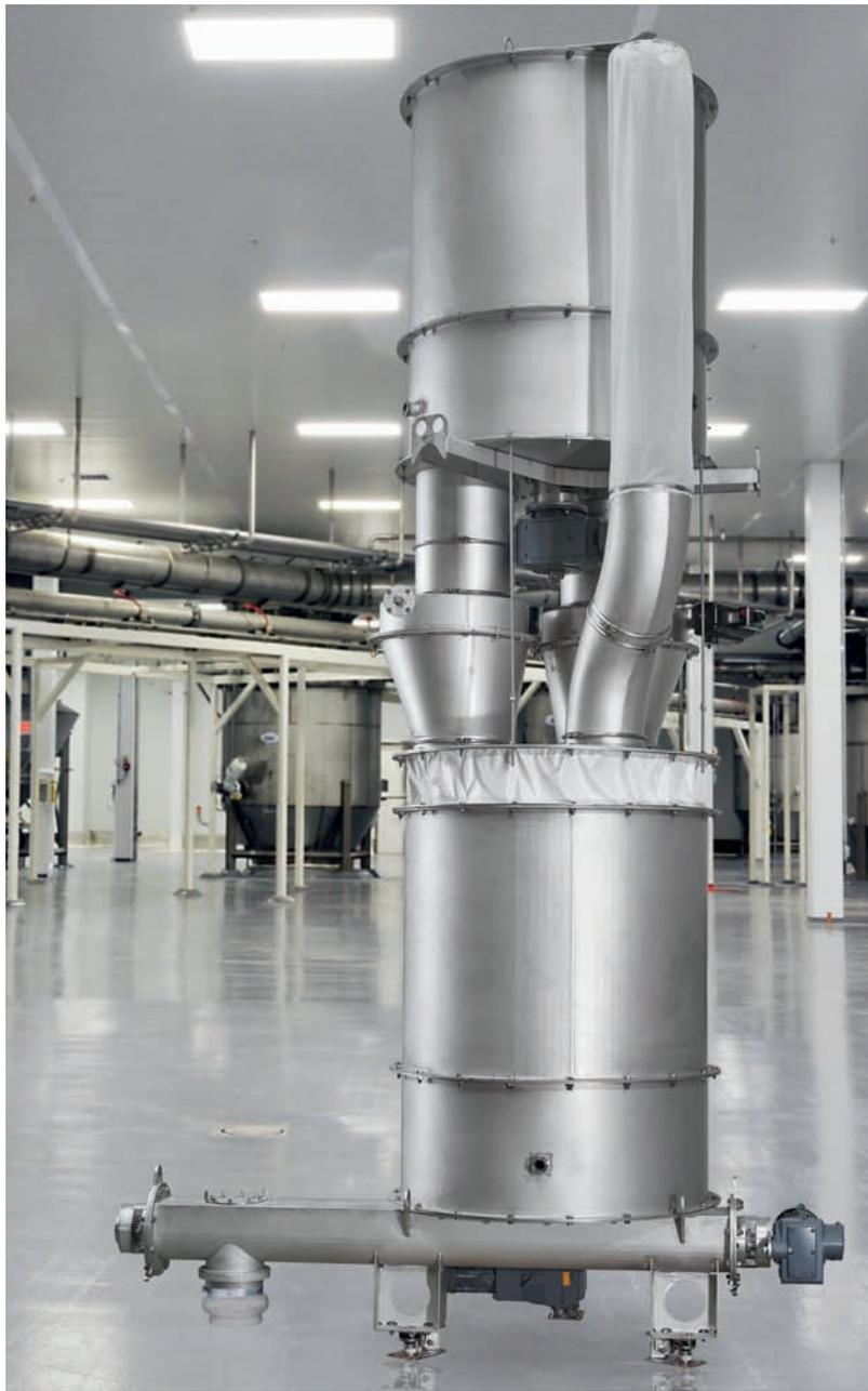
Schenck Process presenta el nuevo Simplex FB, un dosificador por pérdida de peso diseñado para manejar grandes volúmenes de materiales de baja densidad.
