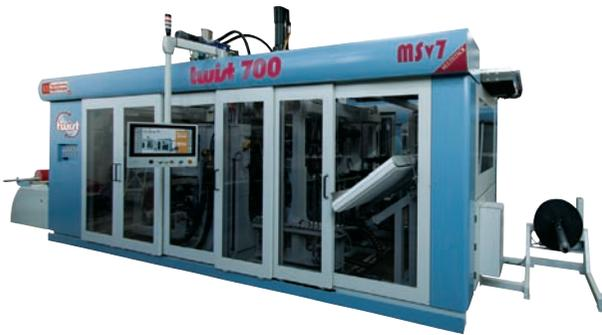
La Twist 700 es una máquina formadora de presión con platina basculante inferior sin levas mecánicas. Sus especificaciones técnicas incluyen un tamaño máximo del molde de 705 x 400 mm, profundidad negativa máxima de 180 mm, fuerza de cierre de 40 toneladas y velocidad máxima de producción de 50 ciclos/minuto.
